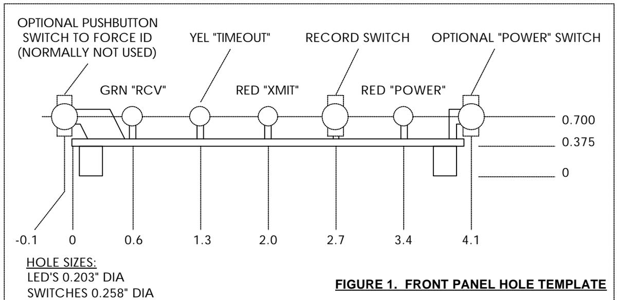
**FIGURE 1. FRONT PANEL HOLE TEMPLATE**
